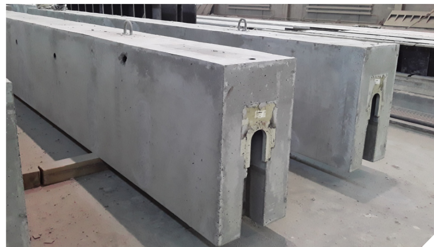
Балки с консольной системой
