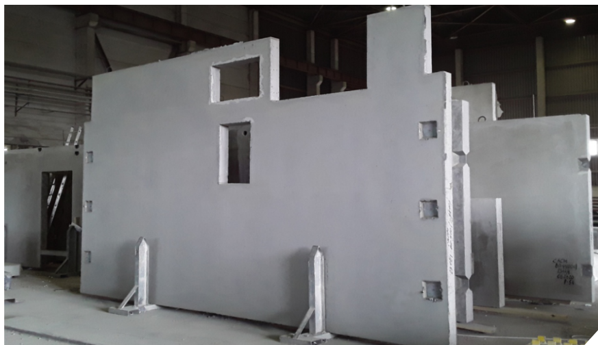
Внутренняя стеновая панель с проемами
