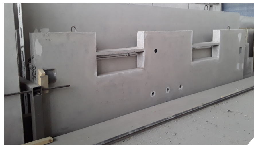
Внутренняя стеновая панель с проемами
