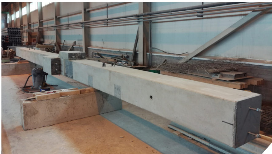
Колонна с консольной системой
