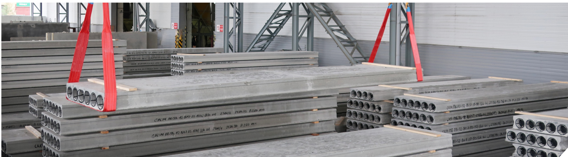
Длина пустотных плит до 9 метров
